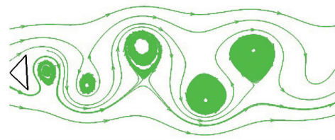
图 8 非对称尖劈绕流一个周期内的压力等值线云图 Fig. 8 Pressure contours of flow past an asymmetric wedge in one period
